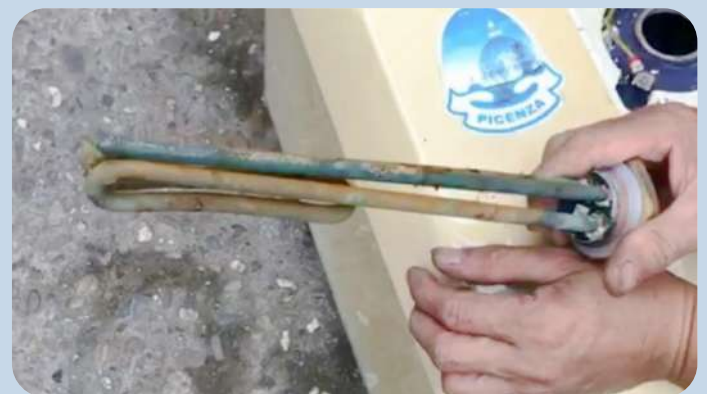
Dây may xo sau khi lắp ActivFlo, sử dụng từ 4-6 tuần
